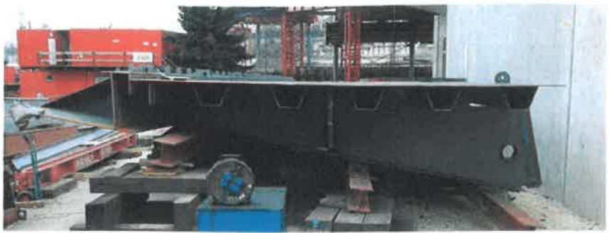
9 10 Gehweg im Normalbereich aus Gesimskasten mit Fahrbahn und Zweitbauteil im Werk und nach Vormontage © SEH Engineering GmbH
