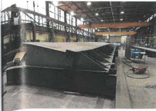
9 10 Gehweg im Normalbereich aus Gesimskasten mit Fahrbahn und Zweitbauteil im Werk und nach Vormontage © SEH Engineering GmbH
