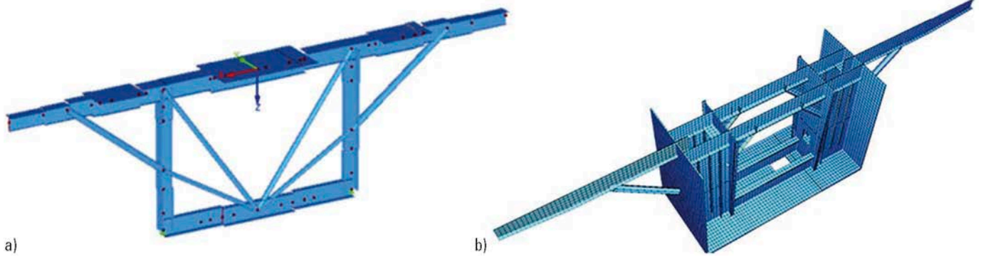
Bild 12 Modelle: a) Querverband und b) Auflagerquerrahmen Modelling of the a) transverse bracing and b) pier transverse system
